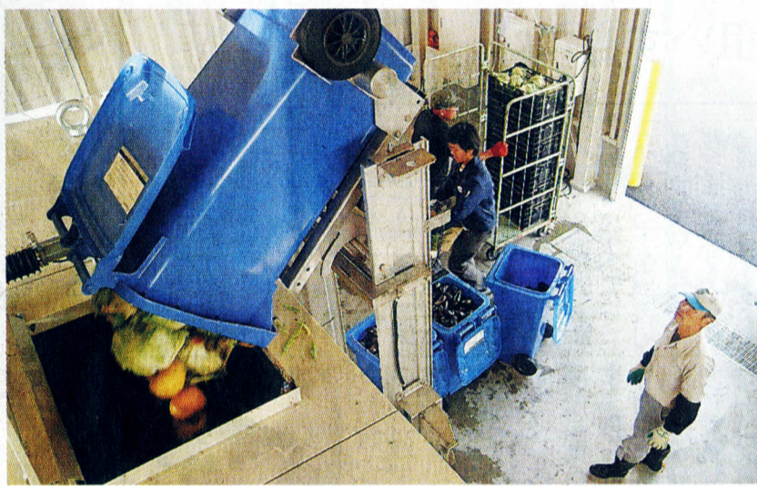
ボタンを押すと、ごみ箱の野菜くずが装置内に放り込まれた。新潟市中央卸売市場で
